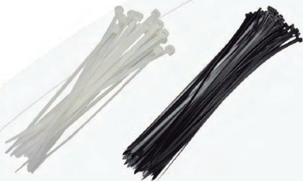
Fabricadas em nylon anti-inflamável com excelentes propriedades dielétricas, podendo ser utilizadas numa faixa de temperatura de -20°C a +80°C. Ranhuras internas seguram cabos e feixes mesmo no caso de vibração. A flexibilidade e elasticidade do material possibilita uma simples e fácil colocação com ou sem o uso de ferramentas. Disponível na cor natural e preto.
